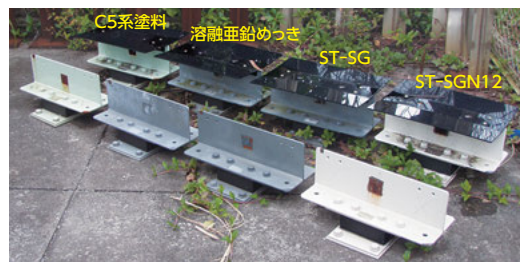
琉球大学構内での大気暴露試験状況
